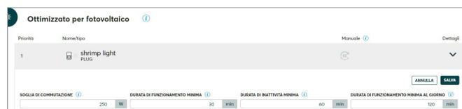
Se l'ottimizzazione solare è attivata per più carichi, in SOLARWATT Manager portal è possibile assegnare priorità con tutta comodità e facilità. Ovvero è possibile definire quale carico deve essere alimentato per primo con il surplus energetico.
