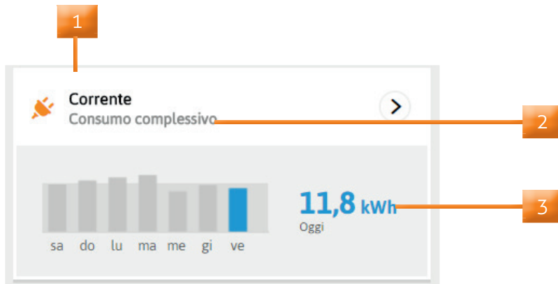
Fig.: Struttura di una finestra di applicazione
