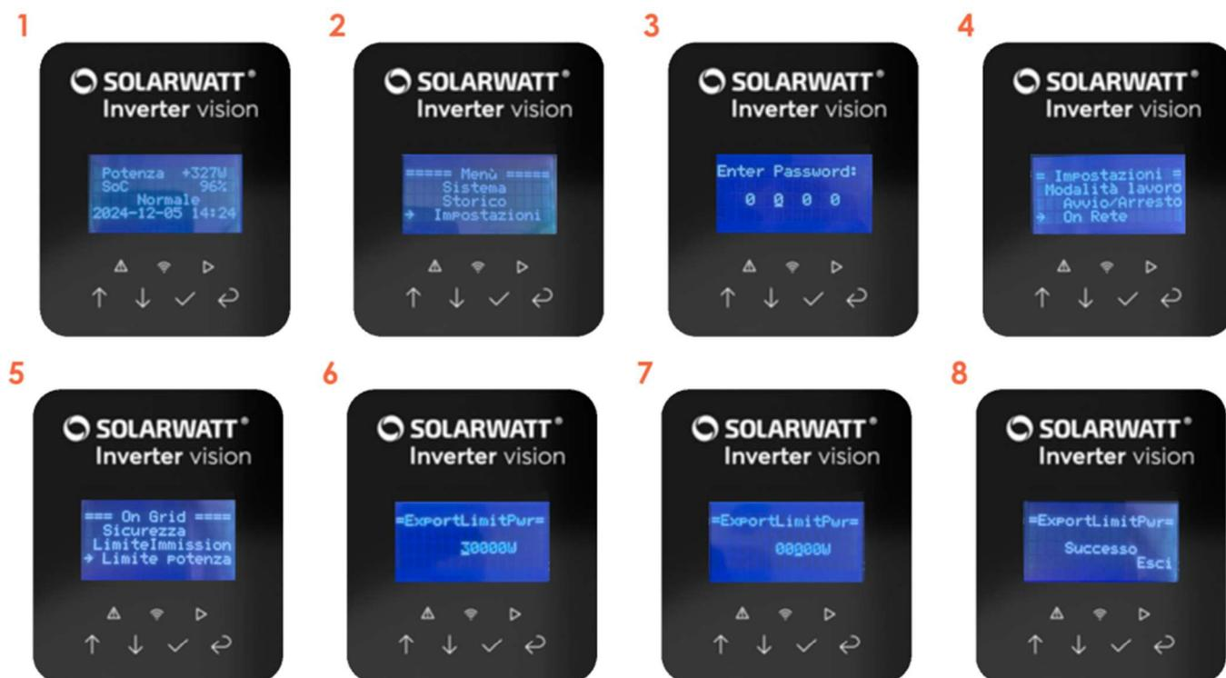
Nota bene: Possibilità di impostare "Feed-in-zero" che equivale a zero immissione in rete.
